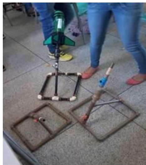
Imagem 02: Bases de lançamento com ângulos variados e foguete modelo ogiva.
